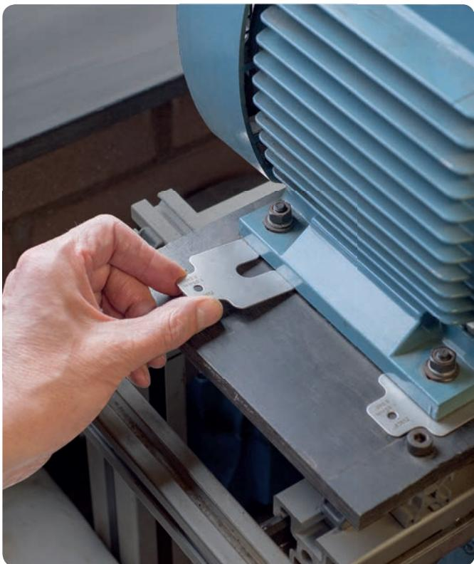
用于精确地调整垂直方向的机器对中
